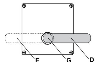
Posición de maneta horizontal en estado abierto.
