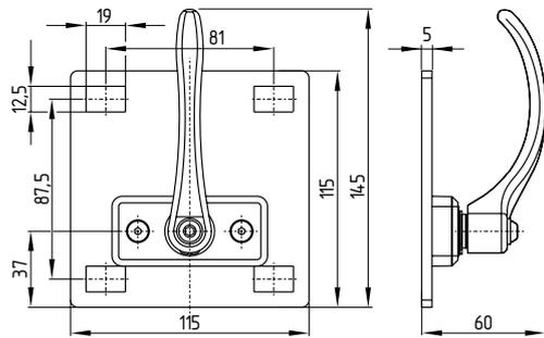
**Desbloqueo de emergencia (anti-pánico) con maneta embutida (metal) P25**
